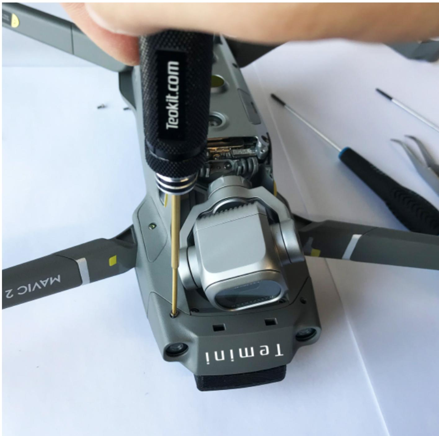
Затем наденьте пластиковую крышку, которую вы отключили на первом этапе и прикрутите ее двумя шурупами шестигранником на 1,5мм.
