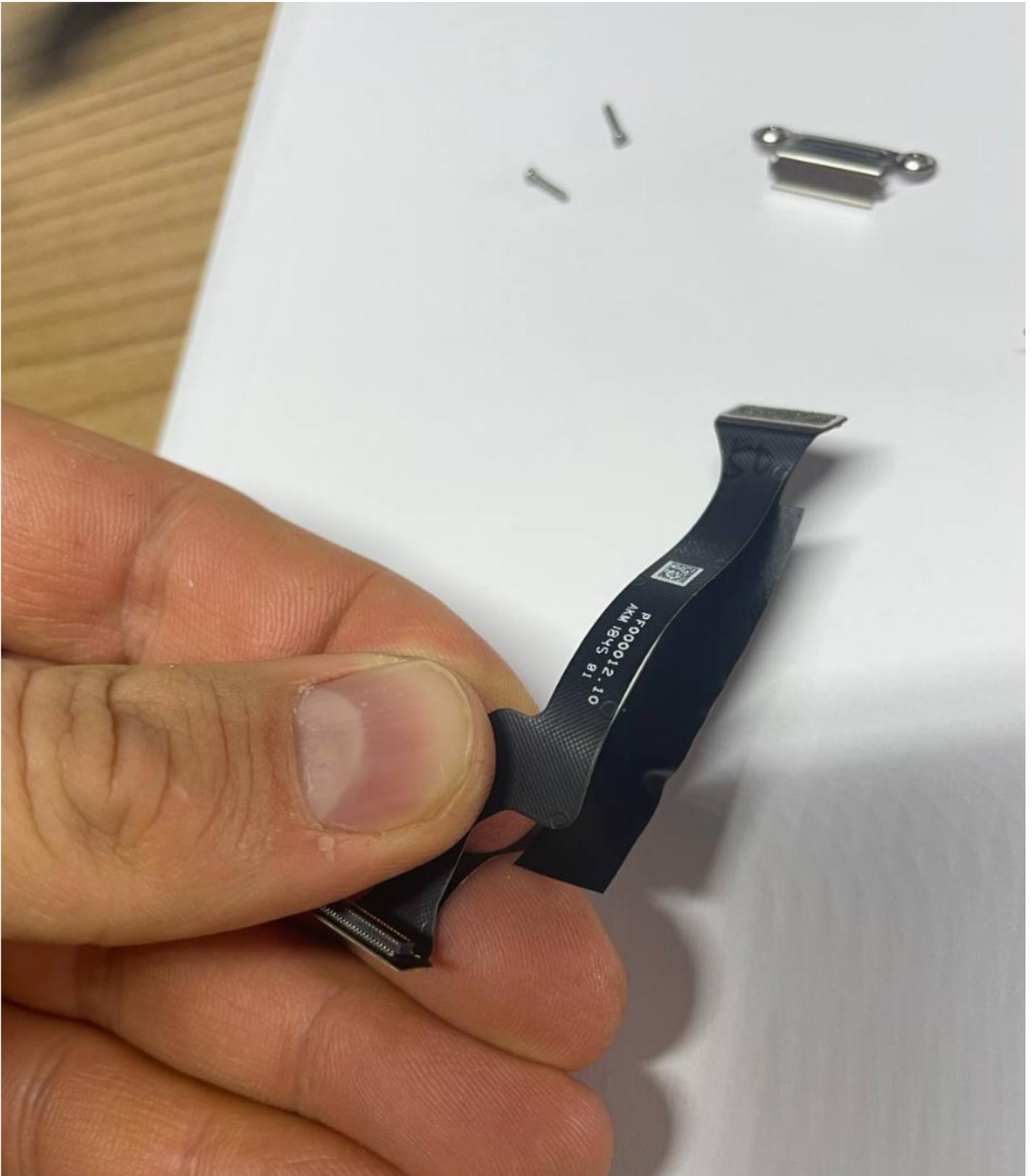
Подключите гибкий кабель стабилизатора к MAshtot, затем прикрепите металлический экран к разъему кабеля, затем используйте винты MAshtot 1,2x5 мм и закрепите кабель и MAshtot на плате стабилизатора с помощью плоской отвертки.
