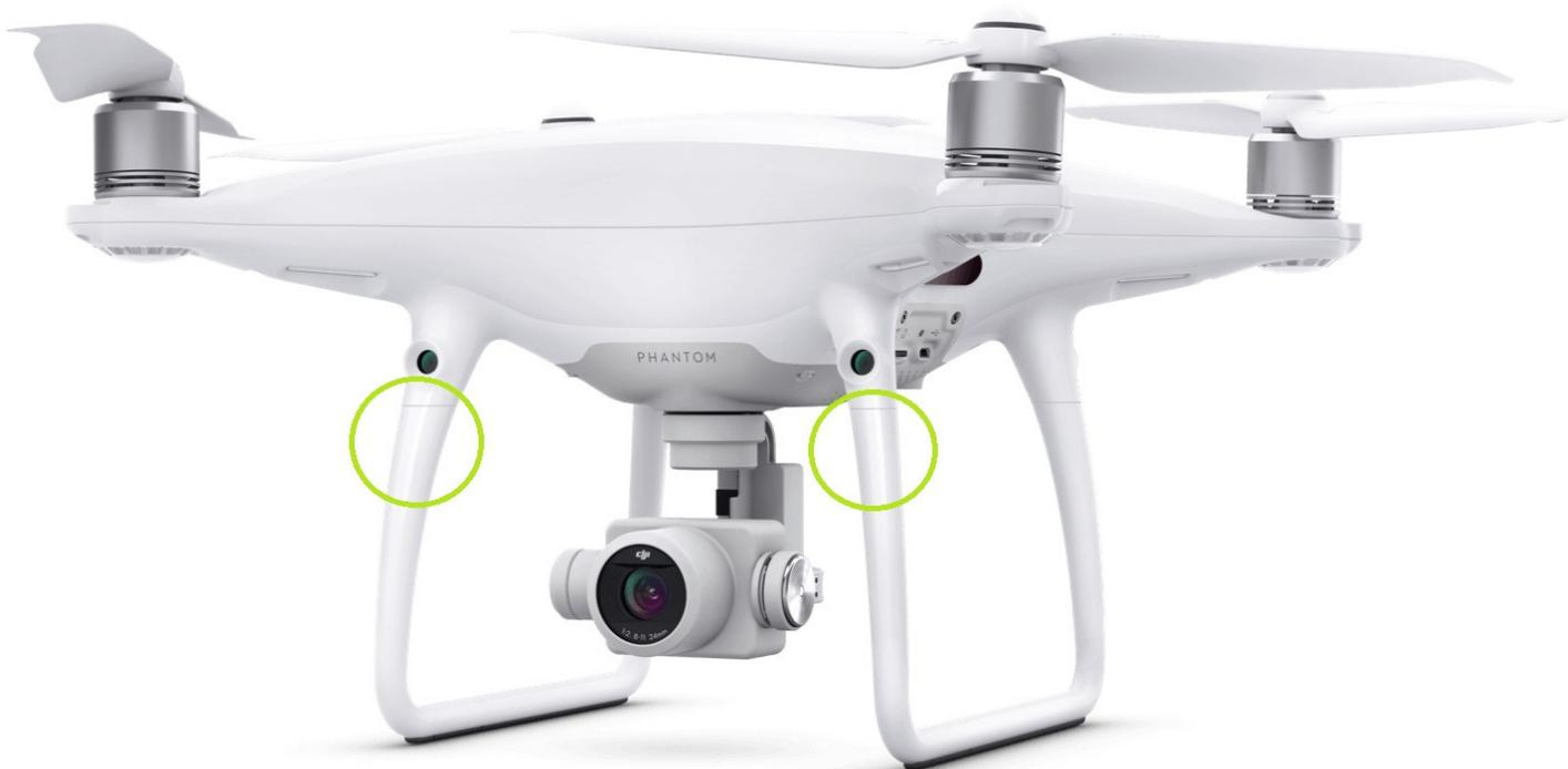
Для размагничивания необходимо приложить Cfixer к крышке компаса и нажать кнопку. После звукового сигнала Cfixer можно убрать.
