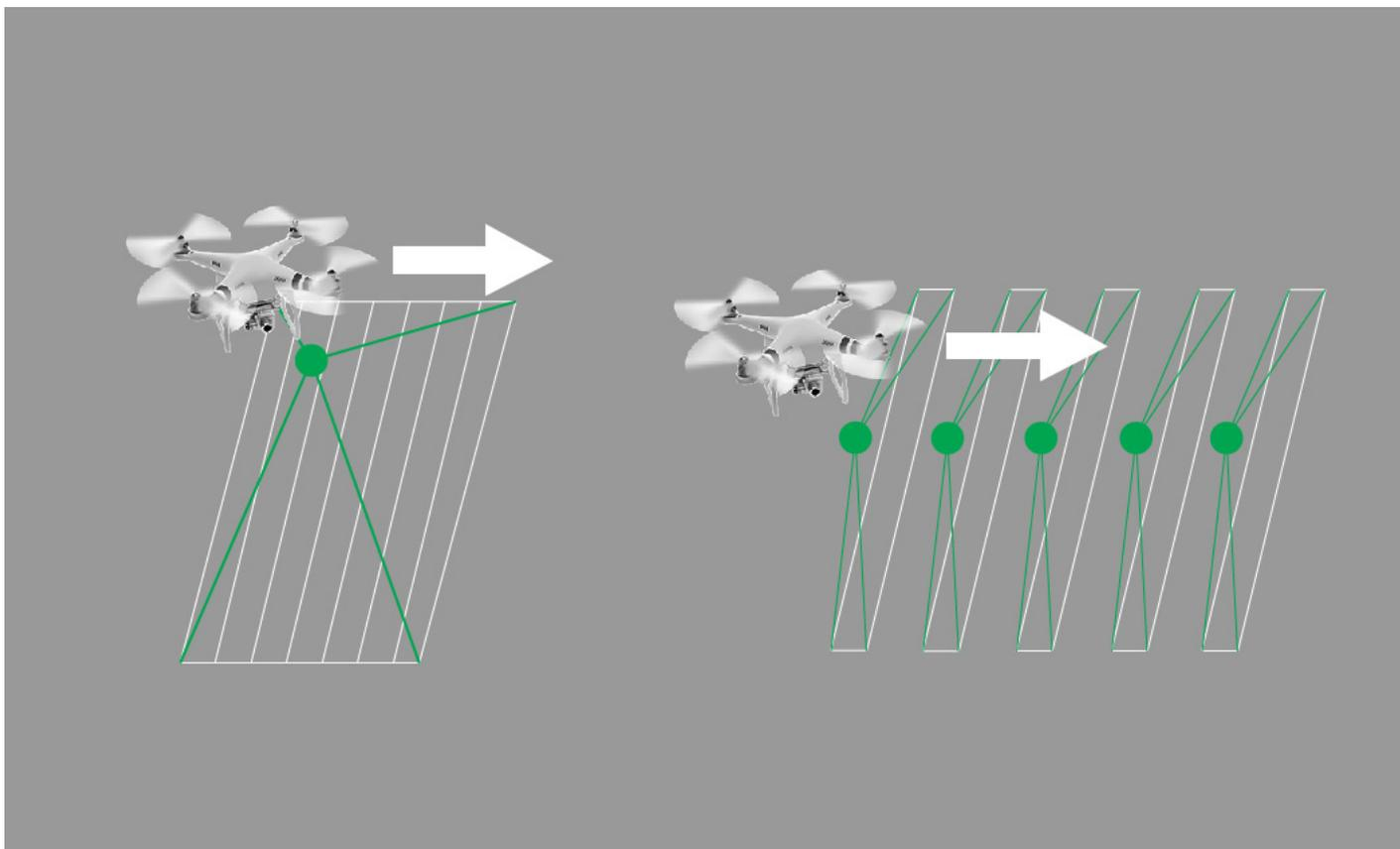
Эти различные положения камеры для каждой строки должны аппроксимироваться путем применения линейной интерполяции между двумя положениями камеры в начале и в конце считывания изображения. Во многих программных продуктах данный функционал не реализован или он не всегда работает корректно.
