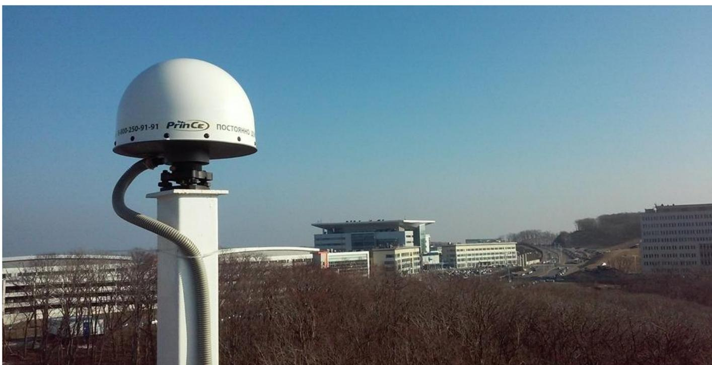
При установке базы на точке с известными координатами необходимо учитывать высоту не до низа крепления антенны, а высоту до фазового центра антенны, обычно на ГНСС приемниках указывается значение от низа крепления (ARP) до фазового центра L1 и L2, разница между этими значениями невелика и можно взять среднее значение.
