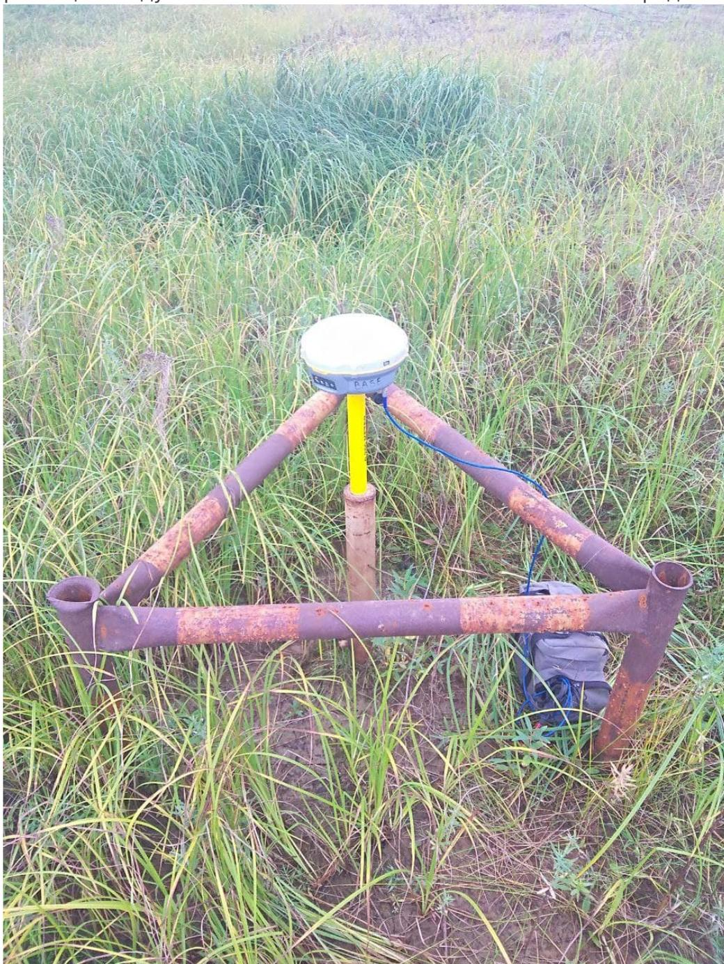
“ Для исключения ошибок определения координат базовой станции используйте не менее 4 пунктов геодезической сети.
